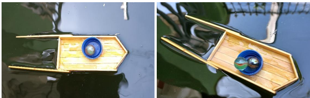
Gambar 8. Ilustrasi uji coba gaya apung perahu menggunakan beban.
